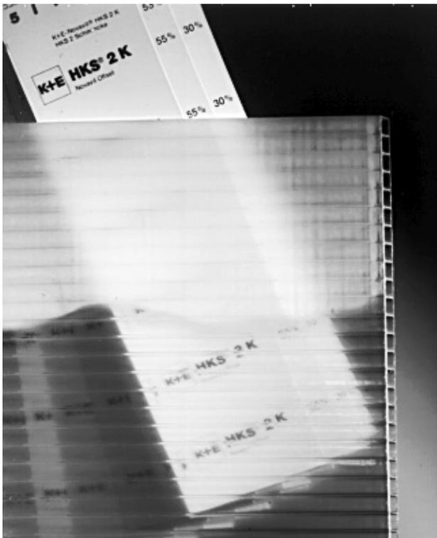
Bild 3: Fotografische Aufnahme einer TOP-beschichteten Doppelstegplatte, die örtlich begrenzt eingetrübt wurde (Probengröße ca. 200 x 400 mm)
