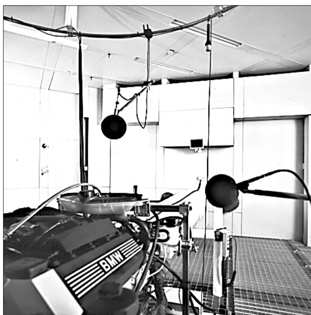
Bild 1: Photographische Aufnahme des Motor-Akustik-Prüfstands bei der BMW AG, München, mit einer bis 50 Hz hochwirksamen reflexionsarmen Auskleidung aus Breitband-Kompakt-Absorbem
