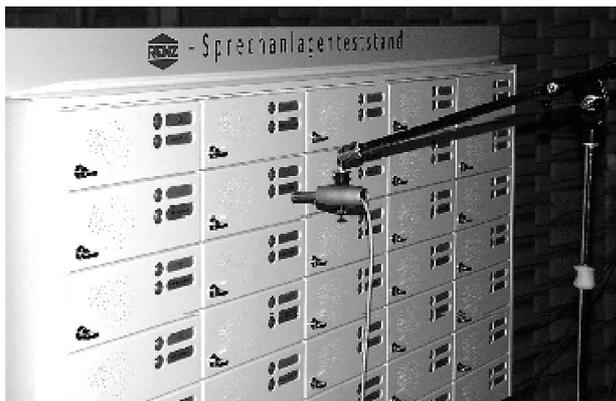
Bild 1: Fotografische Aufnahme eines Briefkastensystems mit verschiedenen eingebauten Gegensprechanlagen (Teststand)
