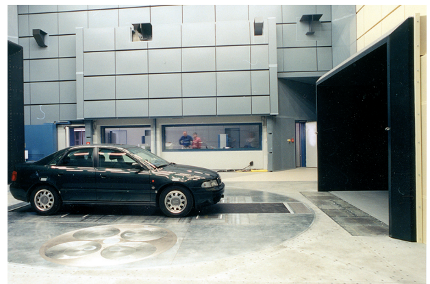
Bild 2: Plenum des aero-akustischen Windkanals von Audi mit BKA-Modulen als Wandverkleidung [4].
