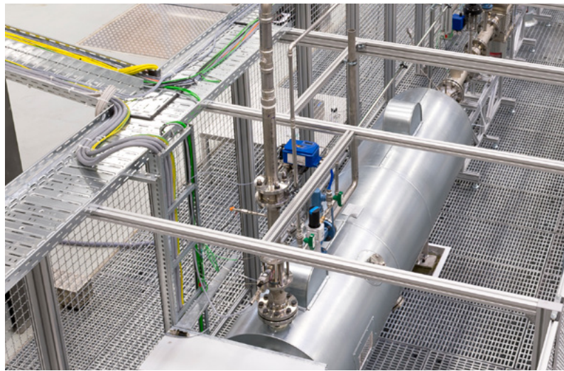
Bleed Air Contamination Simulator (BACS) mit drei Temperaturstufen (550 °C, 200 °C, Raumtemperatur). Mit dieser in Europa bislang einzigartigen Anlage, ist es möglich die Druck- und Temperaturverhältnisse in Teilen eines Strahltriebwerks zu simulieren.
