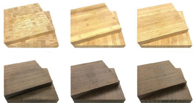
Bambus-Mehrschichtplatten (oben) und Bambus-Scrimber (eine Art Pressspanplatten) in longitudinaler, radialer und tangentialer Richtung.
