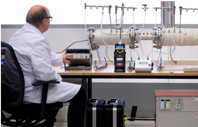
Wirksamkeitsmessungen von Schadstoffkonvertern am kleinen Bleed Air Contamination Simulator (mini-BACS) bei 150–250 °C.
