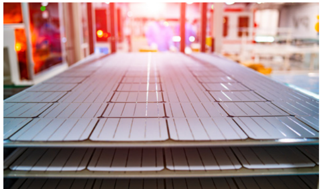
Solarzellen auf kristallinen Siliziumwafern durchlaufen komplexe Produktionsprozesse – Green Manufacturing untersucht diese auf Optimierungspotenziale zur Abfallvermeidung und Kreislaufschließung.
