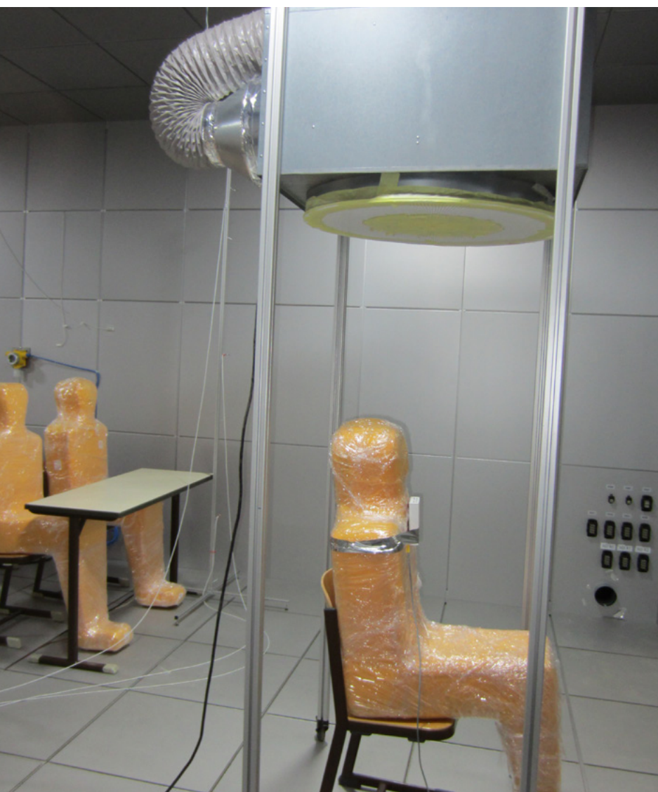
Schutzhimmel mit beheiztem Dummy: Der einströmende, gefilterte Luftschleier schirmt die Person von der Raumluft ab.
