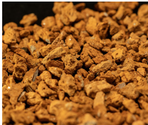
Durch eine automatische Sortierung können Ziegel- und Mörtelbruch voneinander separiert werden.
