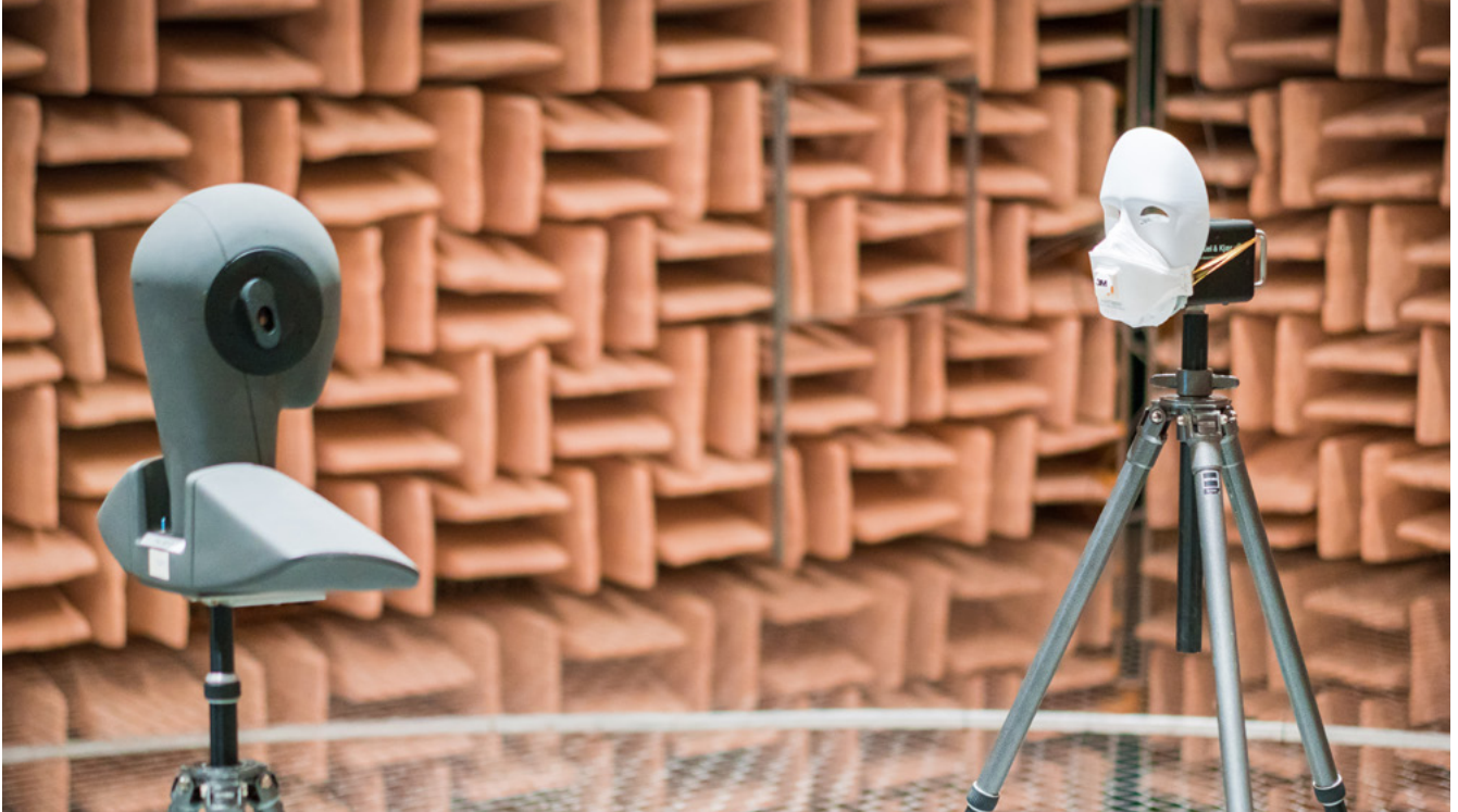
Im Tech-Dialog: Der Dummy mit seinem künstlichen Mund sendet ein vorgegebenes Signal.
