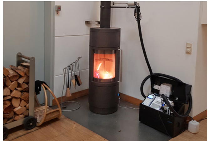
Feldversuch in der Praxis mit einem Kaminofen nach DIN EN 13240 der Firma Hase Kaminofenbau GmbH und integrierter T2O2-Regeltechnologie.
