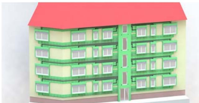
**Bausysteme:** Lüftungs-Kanalführung in der Fassade eines Mehrfamilienhauses, vorgefertigte Fenster und Dämmelemente im Wärmedämmverbund-System.
