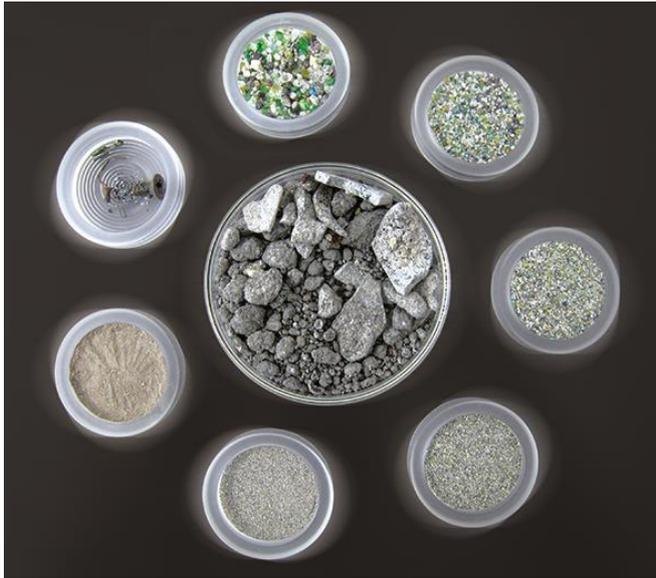
**Durch die elektrodynamische Fragmentierung können aus Müllverbrennungsschlacke noch wertvolle Rohstoffe wiedergewonnen werden.**
