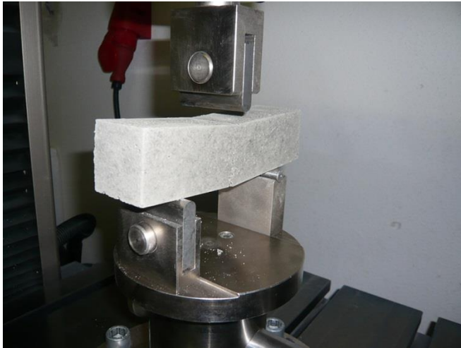
Bestimmung der mechanischen Eigenschaften von Leichtbeton © Fraunhofer IBP
