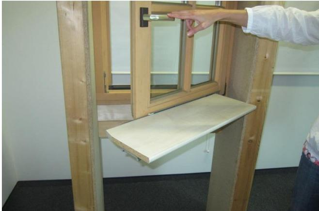
**Abb. 1** Beim Öffnen des Fensters schiebt sich das Fensterbrett über die Führungsschiene nach vorne - ohne an der Laibung der Anschlagseite zu reiben.
