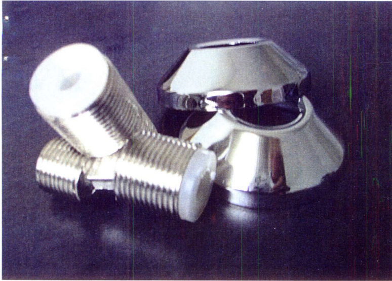
■ Bild 4: Im Gegensatz zu den übrigen Armaturen verfügten alle Armaturen mit ABP über S-Anschlüsse mit Wasserschalldämpfer. Hieraus ergibt sich, dass die eingebauten Dämpfer als wichtigste Ursache für die unterschiedliche Geräusentwicklung der Armaturen anzusehen sind.
