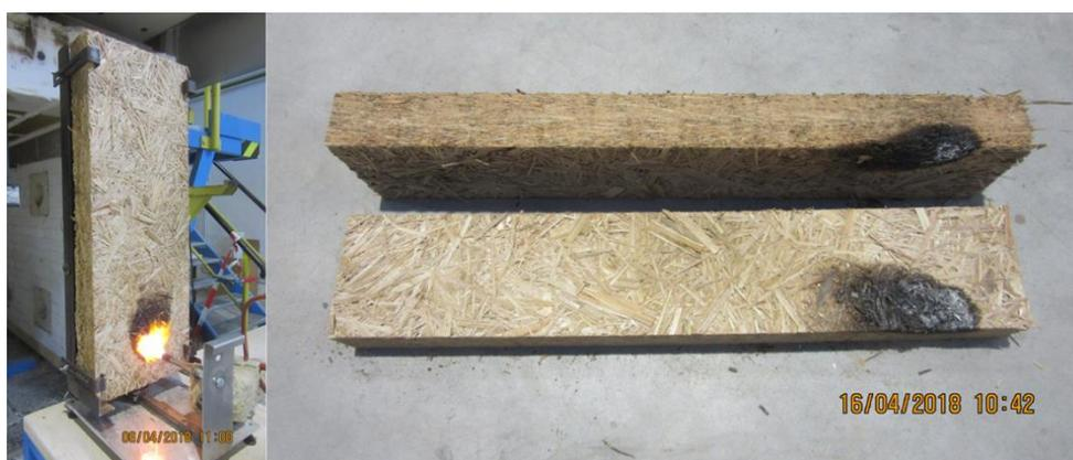
Bild 33: Prüfaufbau des Glimmtestes (links) und Prüfergebnis der durch den Holzwolle-Produktionsprozess hergestellten Typha-Probeplatten.
