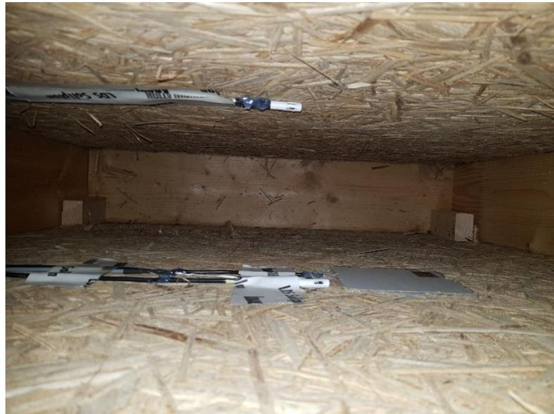
Bild 99: Messsensorik auf der zum Raum liegenden Seite (im Bild unten) mit Kombi-sensor, Oberflächentempersensur sowie Wärmefluss-scheibe und der Außenseite (im Bild oben) mit Kombi-sensor.
