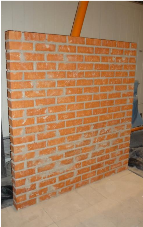
Bild 9: Wände 3 (Vollziegel) und 4 (Porenbeton-Plansteine).
