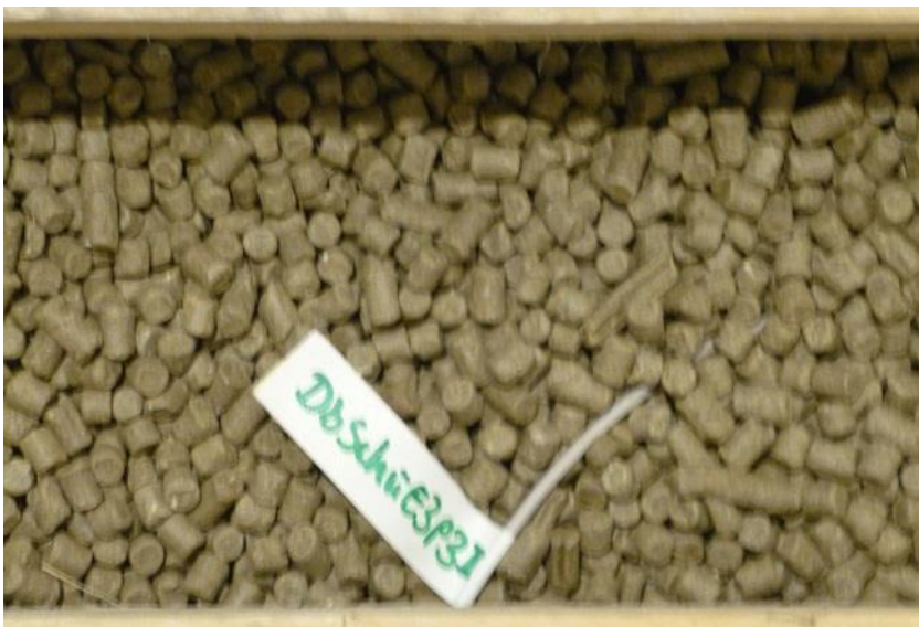
Bild 20: Detailansicht der Schüttung von Raum D (Lehmpellets) mit einem integrierten Widerstandssensor.
