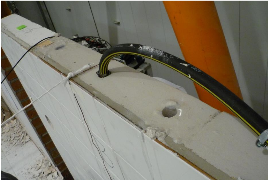
Bild 38: Bewässerung der Wand 4 von oben für ca. 22 Stunden.
