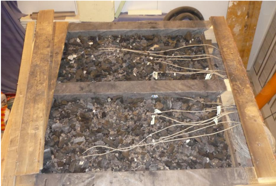
Bild 19: Schüttung von Raum C (Schlacke, Holzkohle) mit den installierten Widerstandssensoren.
