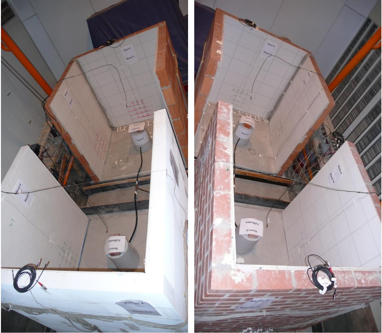
Bild 31: Gesamtansicht der Prüfräume E, F, G und H im Klimasimulator.
