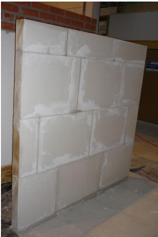
Bild 8: Wand 1 (Gipswandbauplatten) und Dämmung von Wand 2 (Leichtbauwand).
