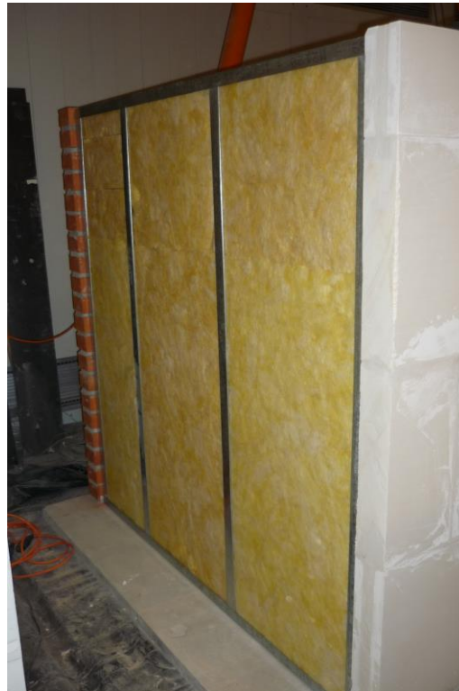
Bild 8: Wand 1 (Gipswandbauplatten) und Dämmung von Wand 2 (Leichtbauwand).
