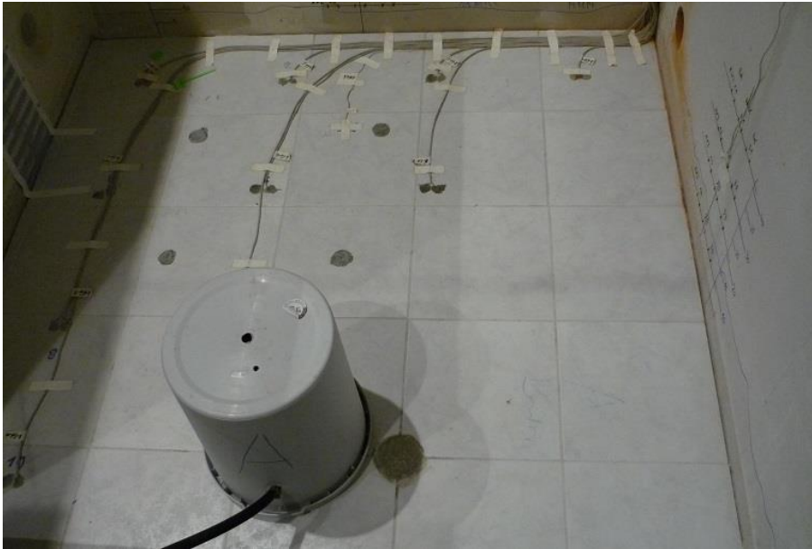
Bild 36: Simulation eines Wasserschadens an den Fußboden- und Wandaufbauten.
