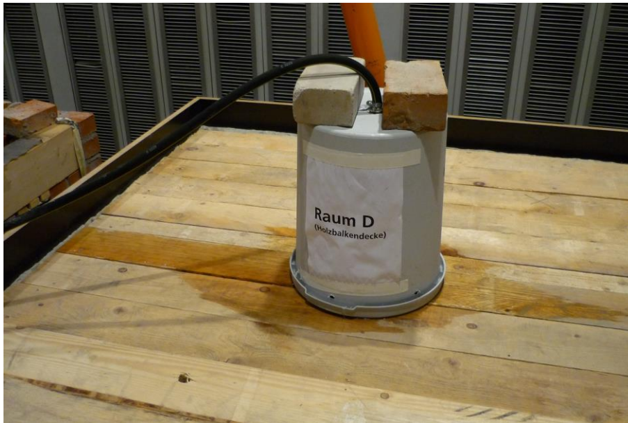
Bild 41: Erzeugung eines Wasserschadens bei den Deckenaufbauten (Raum D, Lehmpelletfüllung).
