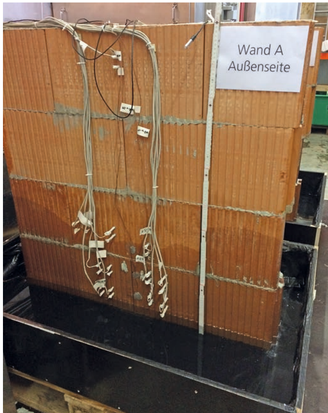
Bild 5. Sichtbarer Feuchteanstieg an der Außenseite von Wand A am Ende der Bewässerung Fig. 5. Visible increase of moisture at the outside of wall A at the end of the wall irrigation
