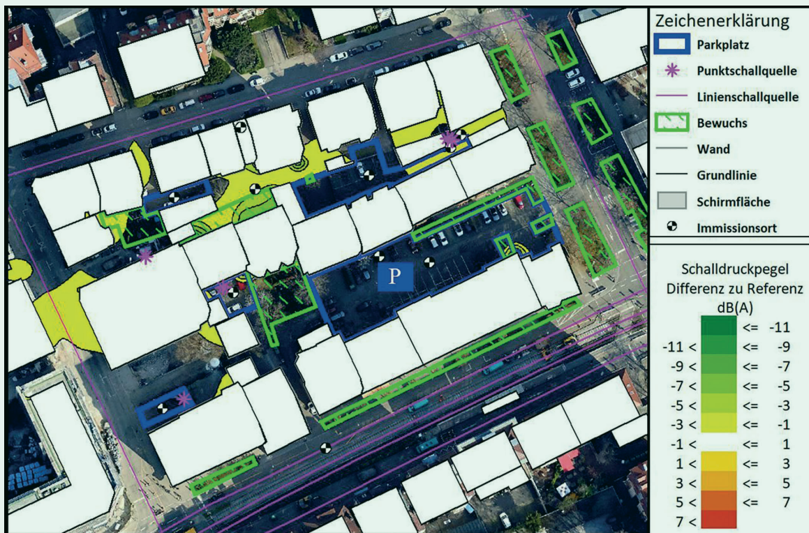
Bild 3 Schallimmissionspegeldifferenz zur Ausgangssituation. Reduzierung durch schallabsorbierend ausgekleideten Fassadenanteil (65 %) in Fassadennähe bis zu 7 dB(A) möglich. Erstellt mit SoundPlan®; Luftaufnahme-Foto: Stadt Stuttgart
